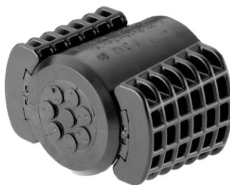
**Назначение:** делимый уплотнитель EZA-t, предназначен для герметизации пространства между микротрубкой и ПЭ трубой (Ø32, 40, 50 и 63 мм). Может быть использован неоднократно.
