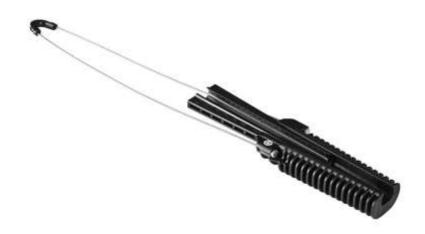
Предназначен для подвески круглых самонесущих кабелей типа ОКСН при воздушной прокладке. Состоит из открытого конического корпуса, усиленного стекловолокном, пары пластиковых клиньев и гибкой петли из нержавеющей стали 250-500 мм.
