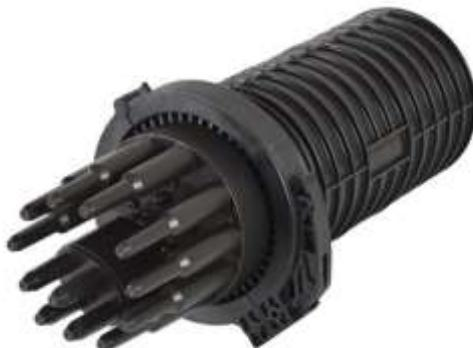
Предназначена для монтажа подвесных самонесущих ОК и оптических кабелей с вынесенным силовым элементом типа «8», а также городских кабелей любых конструкций, в том числе и с броней из стальной гофрированной ленты. В муфте предусмотрен овальный ввод для транзитной петли оптических модулей без разрезания. Выкладка петли модулей осуществляется на лотке с противоположной стороны от кассет.
