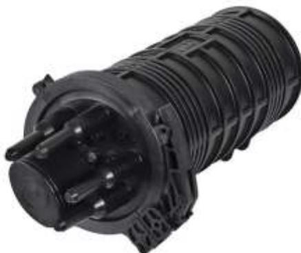
Предназначена для монтажа подвесных самонесущих ОК, оптических кабелей с вынесенным силовым элементом типа «8», а также городских кабелей любых конструкций, в том числе и с броней из стальной гофрированной ленты. В муфте предусмотрен овальный ввод для транзитной петли оптических модулей без разрезания. Выкладка петли модулей осуществляется на лотке с противоположной стороны от кассет, размер транзитной петли определяется при монтаже.
