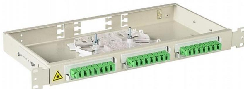
Кросс оптический стоечный серии ШКОС-Л предназначен для установки в стойки 19", 21", 23". Крепление кабеля по оболочке осуществляется металлическим хомутом и/или нейлоновыми стяжками, на Т-образном лепестке. Центральный силовой элемент крепится при помощи металлической скобы. Сменные пластиковые планки на 4 и 8 отверстий обеспечивают установку адаптеров-розеток различных типов: FC, SC, ST, дуплекс LC.
