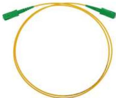
Предназначен для коммутации между активным оборудованием, оптическими кроссами и для соединения оптических портов в волоконно-оптических кабельных системах (ВОКС). Одноволоконный кабель имеет наружный диаметр 2,0 мм или 3,0 мм, оболочка выполнена из полимера не распространяющего горение. Для увеличения механических характеристик в структуре кабеля предусмотрены усиливающие арамидные нити под оболочкой. Возможен заказ патч-корда любой длины.
