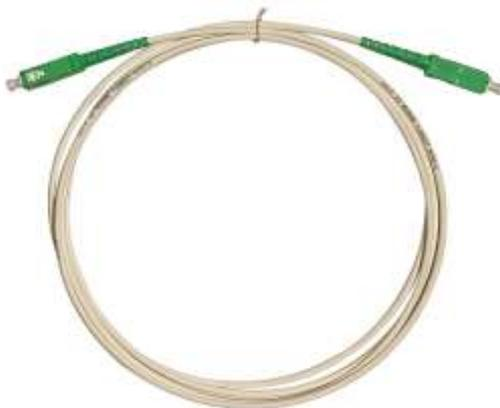
Предназначен для использования в сетях FTTH в условиях, подразумевающих изгибы малого радиуса. В кабелях используется одномодовое волокно стандарта G.657A, допускающее многократные изгибы с радиусом 15 мм.
