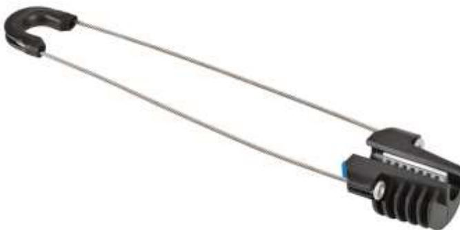
Предназначен для крепления и поддержки кабеля с обеспечением требуемого натяжения кабельной линии. Состоит из открытого конического корпуса, пары металлических зубчатых клиньев (зажимное устройство) и гибкой петли. Все детали соединены между собой и не могут быть утеряны. Устанавливается парами в начале, конце и в интервале 5-ти опор по протяженности кабельной линии. Обеспечивает значительное сокращение продолжительности процесса подвес кабеля.
